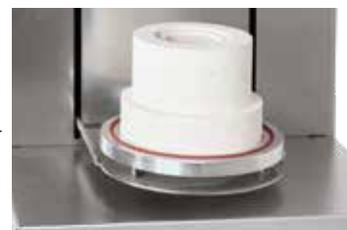
Опускаемый подъемный стол с уплотнением в герметичном исполнении до 1200 °C
