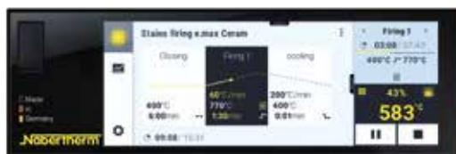
Контроллер с сенсорным управлением для свободного программирования обжига обычной облицовочной керамики
