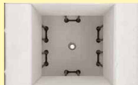
Превосходная однородность температуры благодаря круговому обогреву печного пространства
