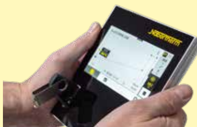
Запись технологических данных подключенного контроллера с помощью USB-накопителя
